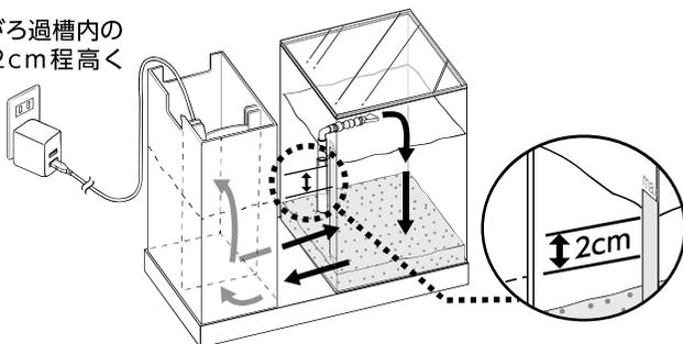
※空気がポンプ内に残ると、ポンプから異音が発生する場合があります。その場合は、一度ポンプを取り出して、水の入った容器にポンプだけを入れ、電源を入れて問題なく稼働するかを確認してください。一度ポンプ内に水が入れば、ろ過槽内に戻しても異音なく稼働します。
